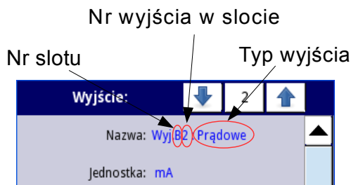
Rys. 7.94. Sposób zapisu Nazwy wyjścia wbudowanego
