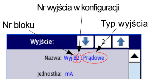
Rys. 7.91. Sposób zapisu Nazwy wyjścia wbudowanego
