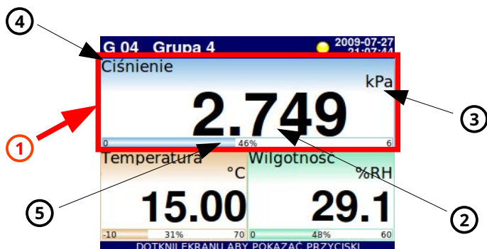
Rys. 6.8. Struktura Panelu pomiarowego
